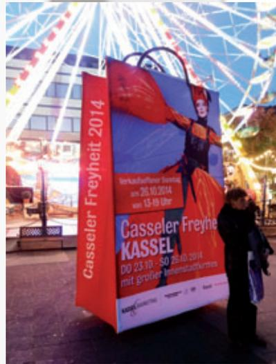
Die textilbezogene Stahlkonstruktion, mit der Größe von 2,00m B x 1,00m Tx 3,00m H, lässt sich auch zu einem Rechteck-Cube umbauen, auf dem dann wirkungsvoll das Programm eines Stadtfestes mit Übersichtsplan präsentiert werden kann.
